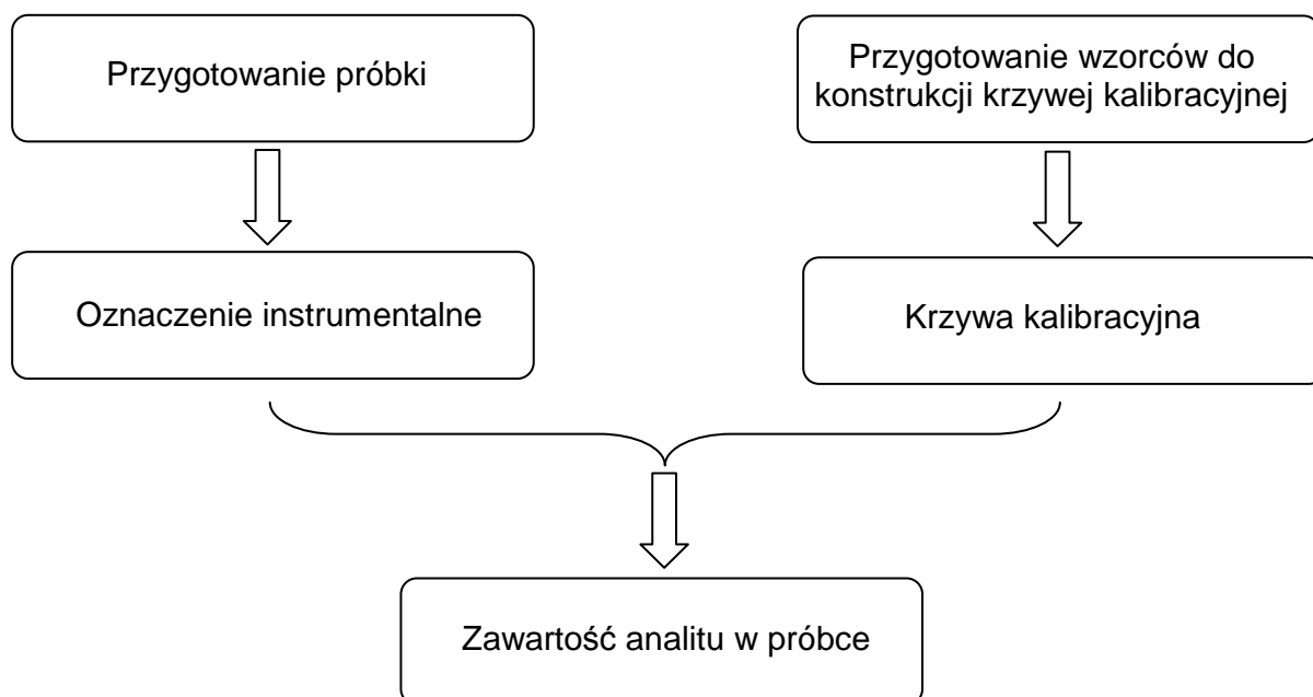
Rys. 2. Schemat ogólnej procedury pomiarowej w analizie chemicznej.
