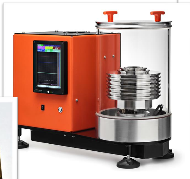
Ciśnieniomierz obciążnikowo-tłokowy do pomiaru ciśnienia absolutnego
