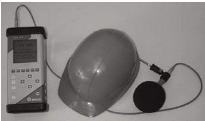
Rysunek 1: Przykład mikrofonu zamocowanego na kasku, z możliwością regulacji położenia i ukierunkowania
